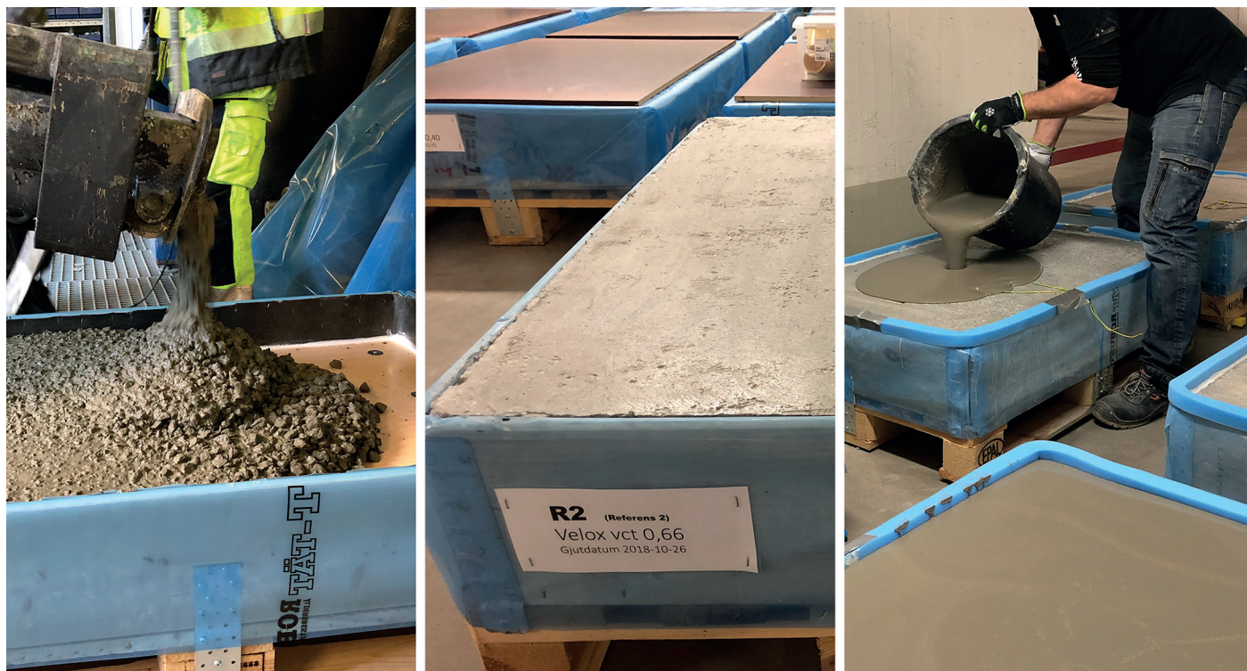
Figur 1: Tillverkning av provkroppar till undersökningen: gjutning (vänster), lagring inkl. själv- eller diffusionsuttorkning (mitten) samt avjämning (höger).
